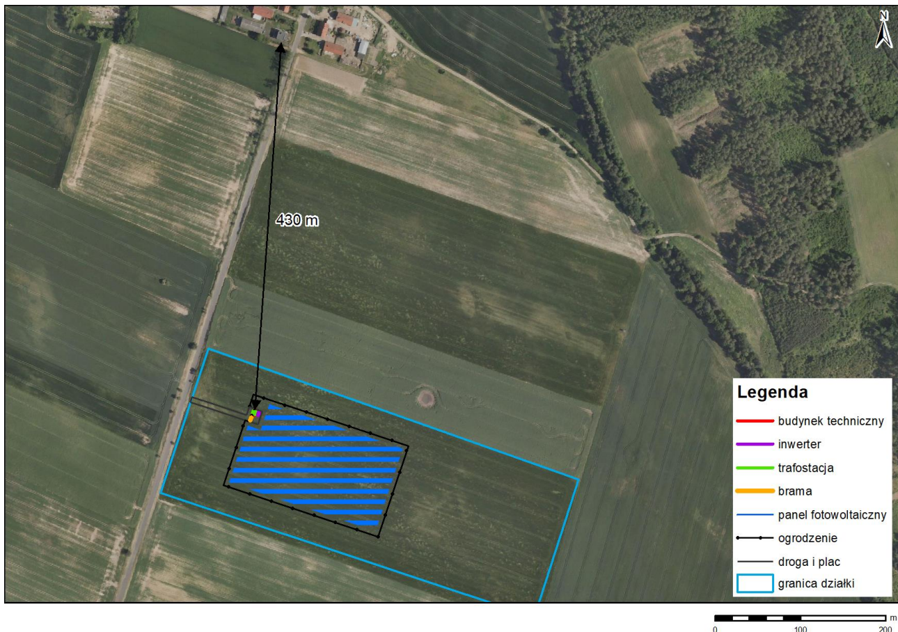
Rysunek 32 Lokalizacja obiektów inwerterów oraz transformatorów w stosunku do najbliższych obszarów chronionych akustycznie
