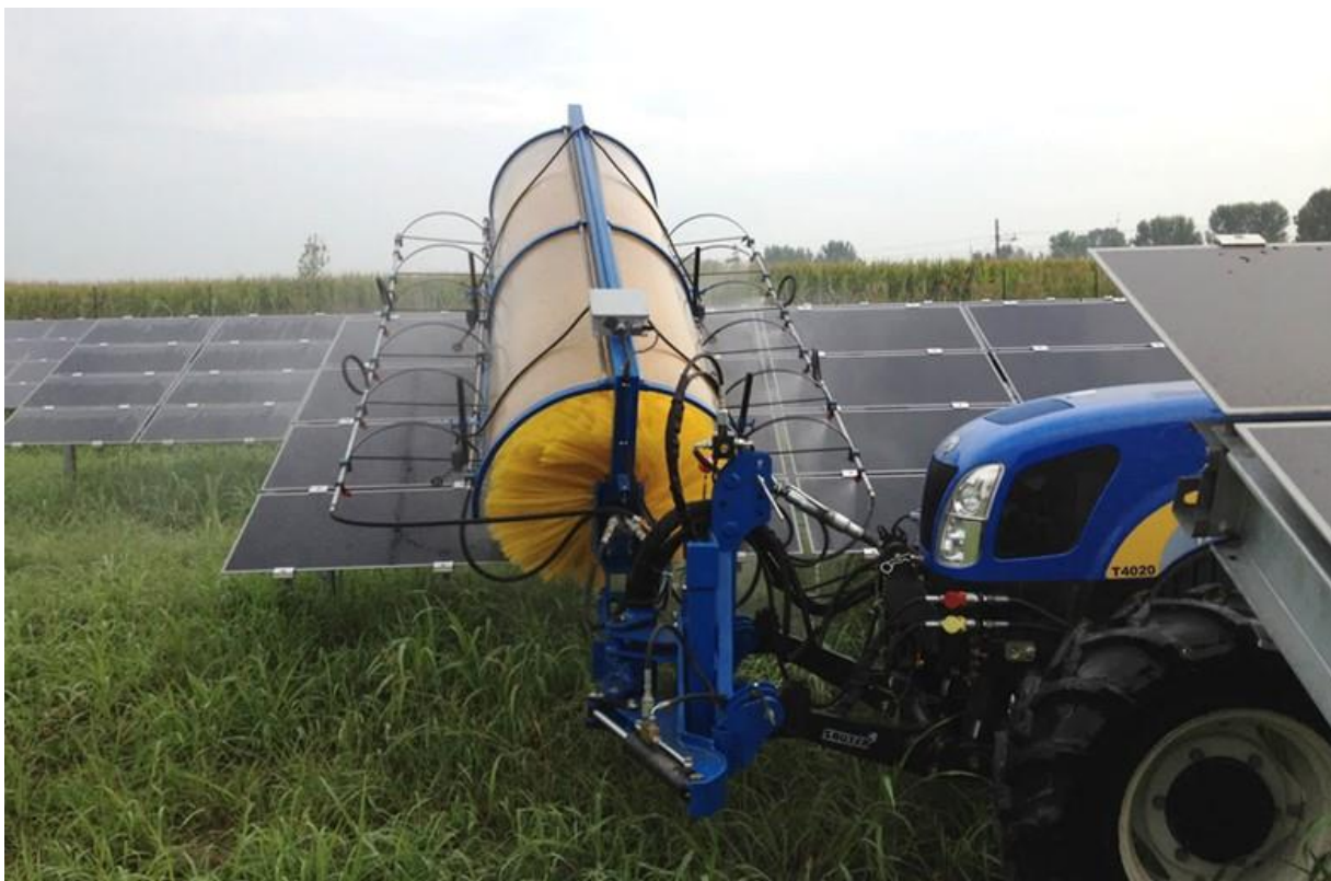
Rysunek 29 Mycie paneli fotowoltaicznych za pomocą specjalnej dostawki do ciągnika rolniczego
