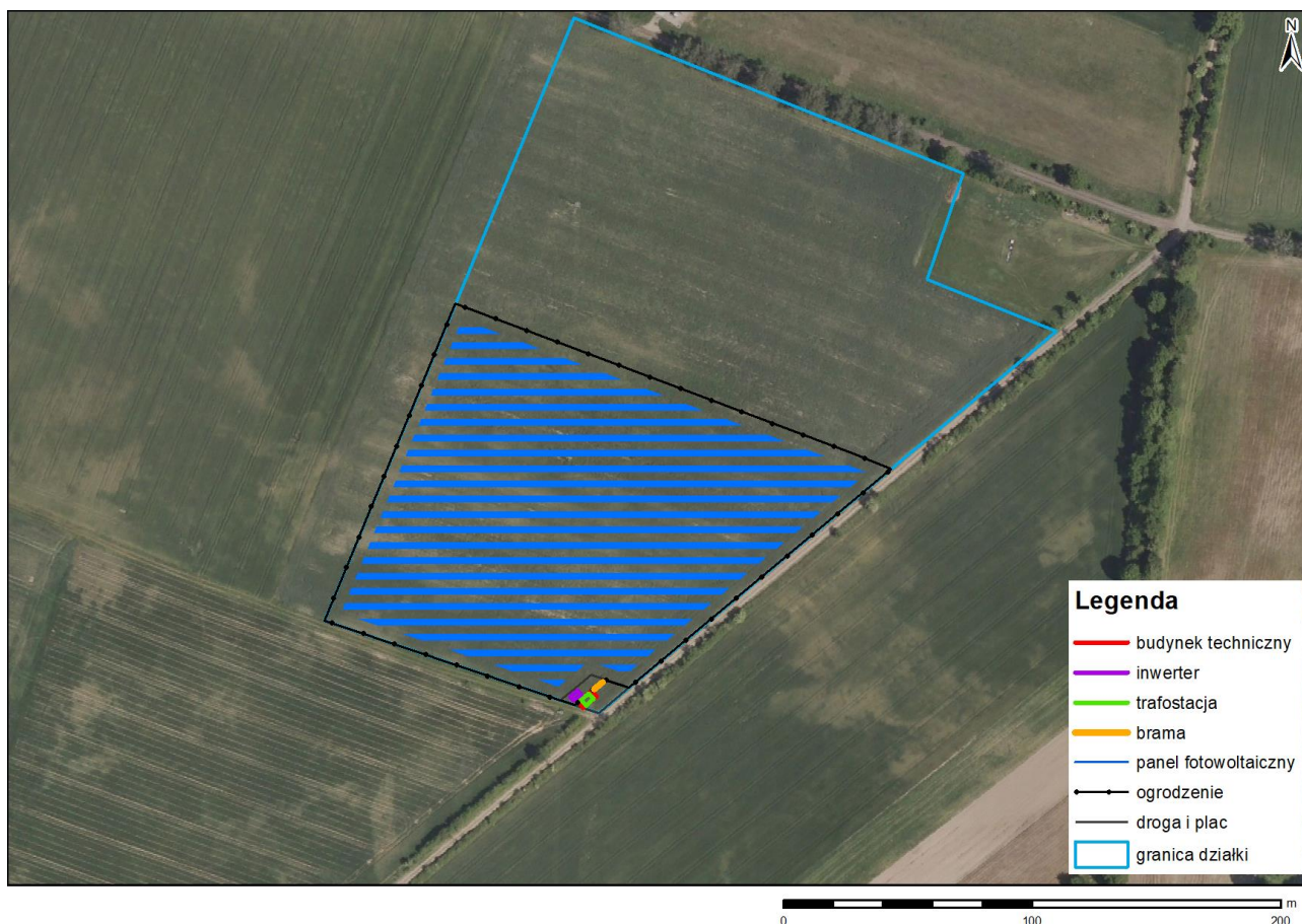
Rysunek 6 Wstępne rozmieszczenie poszczególnych elementów farmy fotowoltaicznej na tle mapy satelitarnej
