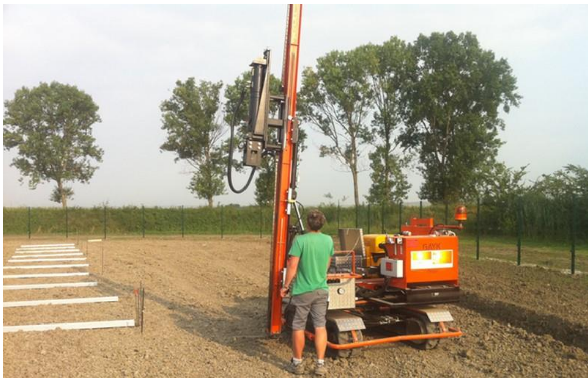
Rysunek 21 Katar do wbijania profili nośnych
