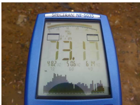
FOTOGRAFIA 9. Pomiar składowej elektrycznej (na lewo) i składowej magnetycznej (na prawo) w punkcie pomiarowym zlokalizowanym w odległości ok 5m od transformatora 15kV [fot. Krzysztof Kręciproch]
