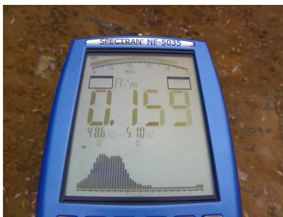
FOTOGRAFIA 9. Pomiar składowej elektrycznej (na lewo) i składowej magnetycznej (na prawo) w punkcie pomiarowym zlokalizowanym w odległości ok 5m od transformatora 15kV [fot. Krzysztof Kręciproch]
