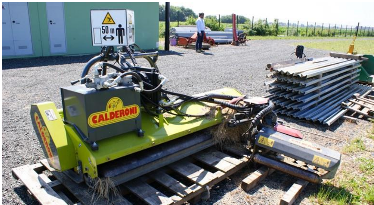
Rysunek 32 Mycie paneli fotowoltaicznych za pomocą specjalnej dostawki do ciągnika rolniczego
