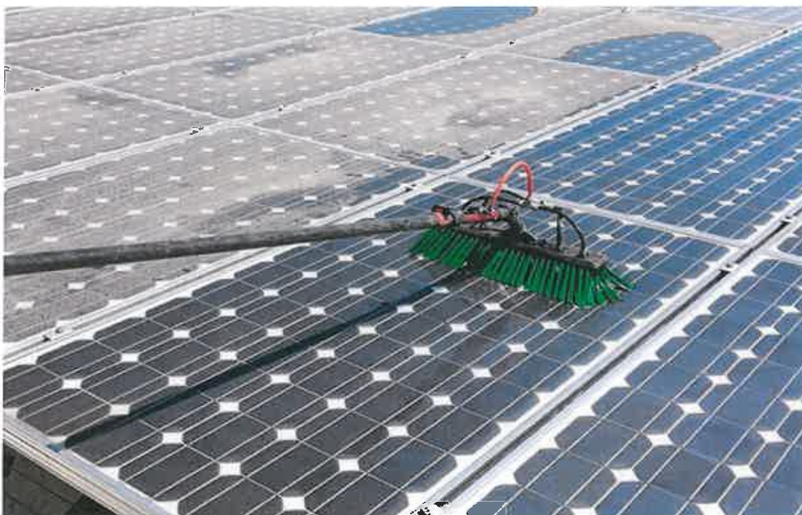
Fot. 6. Szczotka do czyszczenia paneli fotowoltaicznych, ( https://alexprac.pl/index.php/nasze-uslugi/mycie-paneli-fotowoltaicznych/ ).
