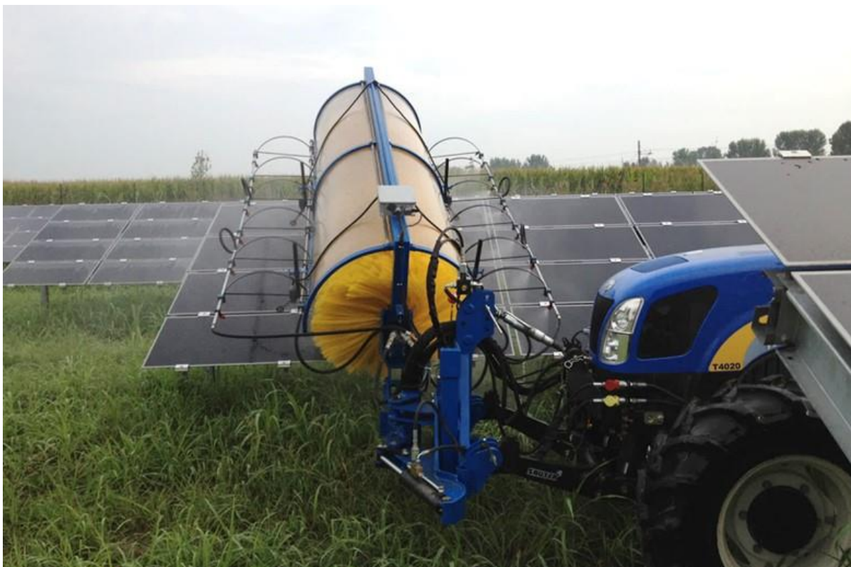
Rysunek 27 Mycie paneli fotowoltaicznych za pomocą specjalnej dostawki do ciągnika rolniczego
