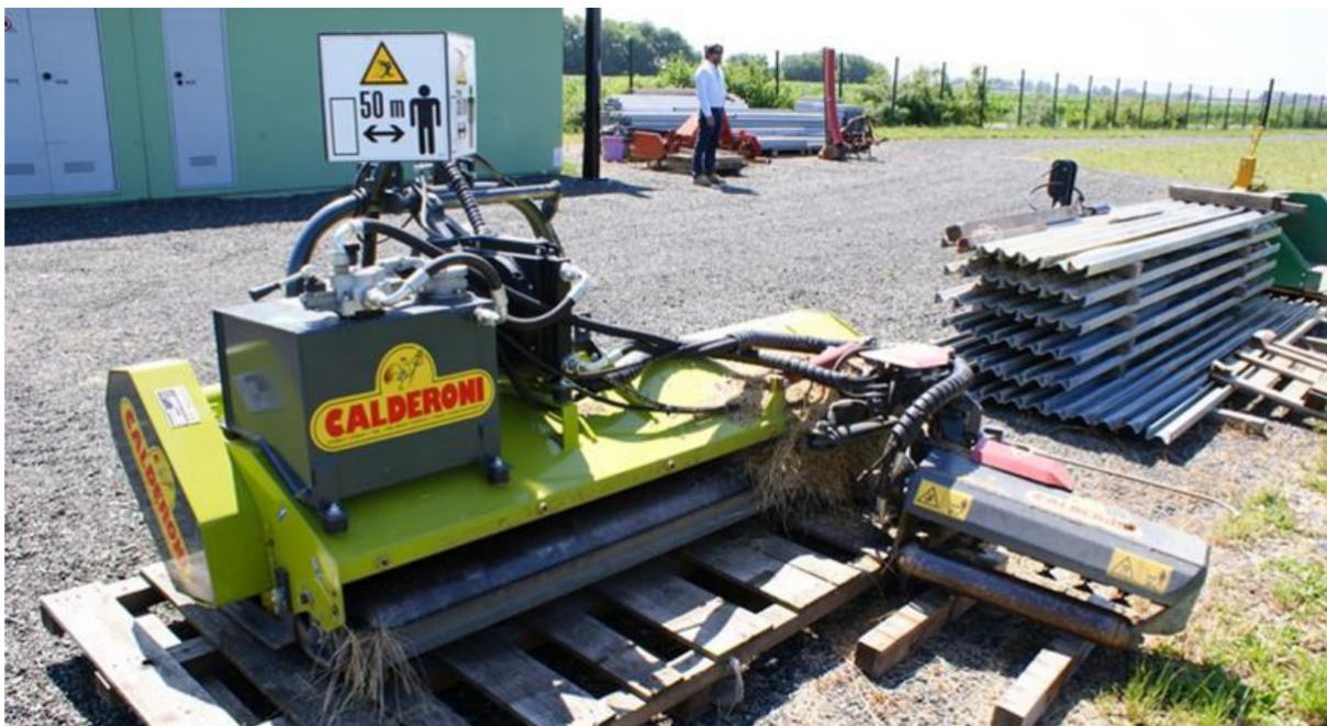
Rysunek 26 Dostawka do ciągnika rolniczego służąca do wykaszania terenu farmy
