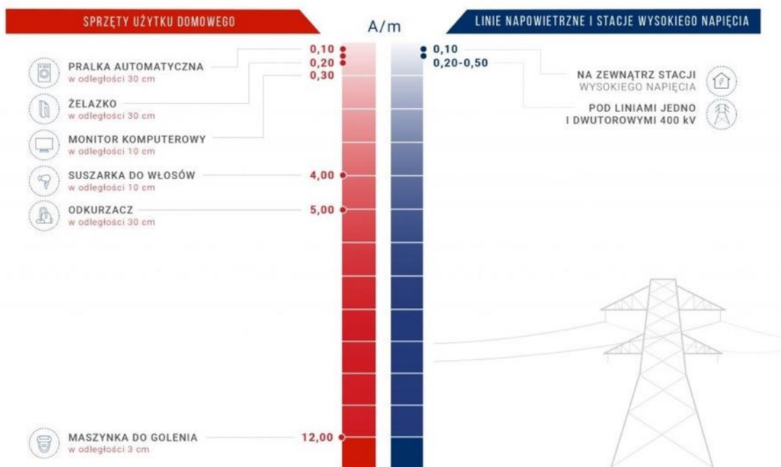
Ryc. 174. Porównanie natężeń pól elektroenergetycznych w otoczeniu człowieka oraz stacjami najwyższych napięć i linii napowietrznych 400 kV.
