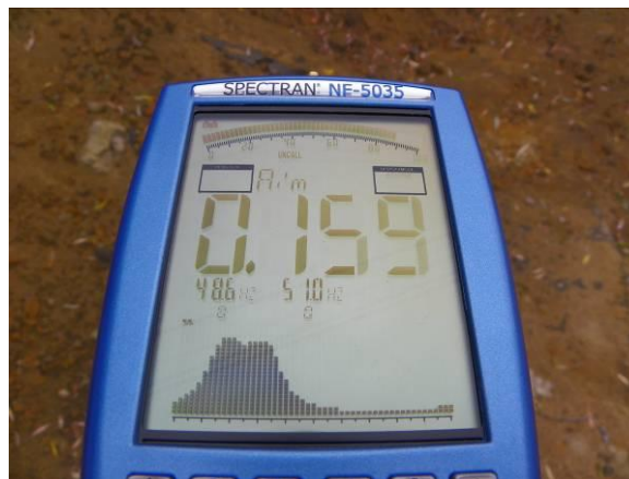
FOTOGRAFIA 14. Pomiar składowej elektrycznej (na lewo) i składowej magnetycznej (na prawo) w punkcie pomiarowym zlokalizowanym w odległości ok 5m od transformatora 15kV [fot. Krzysztof Kręciproch]
