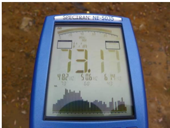
FOTOGRAFIA 14. Pomiar składowej elektrycznej (na lewo) i składowej magnetycznej (na prawo) w punkcie pomiarowym zlokalizowanym w odległości ok 5m od transformatora 15kV [fot. Krzysztof Kręciproch]
